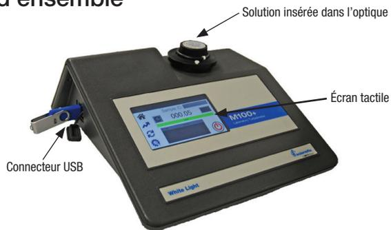
Le M100+ est un turbidimètre de procédé qui permet de mesurer en laboratoire la turbidité de l'eau de l'échantillon. La lumière blanche M100+ a été conçue pour répondre aux critères de conception spécifiés par l'US EPA 180.1 sur la mesure de la turbidité. Le M100+ infrarouge a été conçu pour répondre aux critères spécifiés dans ISO 7027 et DIN 27027 pour la mesure de la turbidité d'un échantillon. Les deux modèles sont dotés de lampes à longue durée de vie.
