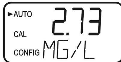
L'écran illustré ci-dessous indique que le système vient d'être démarré ou qu'il vient de passer en mode **AUTO** à partir du mode Service et qu'aucune mesure n'a encore été prise.
