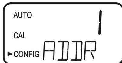
Pour utiliser le mode Modbus, sélectionnez **ASCII** ou **RTU**. Consultez le manuel Modbus disponible auprès de HF Scientific ou en ligne sur [www.hfscientific.com](http://www.hfscientific.com).
