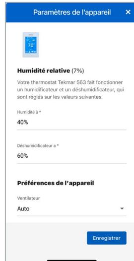
Les Paramètres de l'appareil règlent les unités de température, le ventilateur, l'humidité relative et les points de consigne du plancher.
