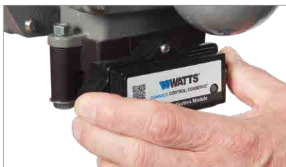
6. Compruebe que el módulo esté completamente asentado para sellar la junta tórica y hacer contacto eléctrico.
