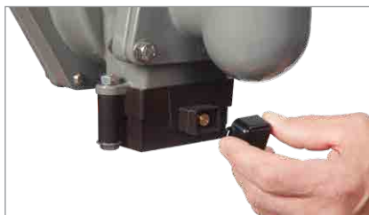
4. Retirez le couvercle antipoussière du capteur.
