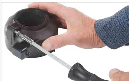
1. Retirez les boulons du capteur d'inondation.
