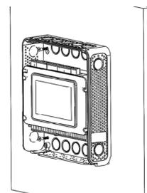
Fixez l'enceinte à un mur en utilisant des vis à bois n° 6 dans les quatre trous de fixation. Utilisez des vis d'ancrage si vous percez la maçonnerie.
