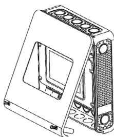
Tirez le couvercle vers vous. La partie supérieure du couvercle pivote sur une charnière. Retirez le couvercle en libérant les crochets du pivot.
