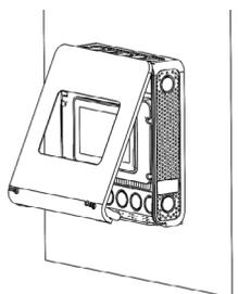
Pour installer le couvercle, accrochez le haut du couvercle à l'enceinte, puis faites pivoter le bas pour le fermer.
