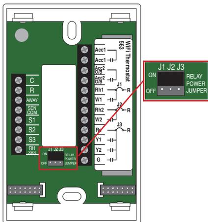
Le thermostat compte trois connecteurs de cavalier d'alimentation de relais situés sous le trou de câblage.
