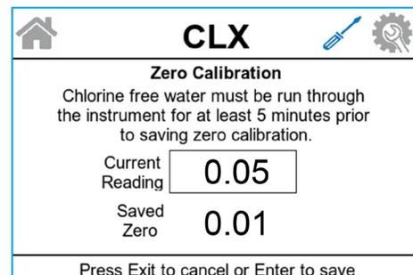
2. L'écran affichera la lecture actuelle sur le CLX. Comme il n'y a pas de chlore, la seule lecture peut être un léger décalage en raison de l'absorbance des réactifs. Aucune couleur rose ne doit être développée.
