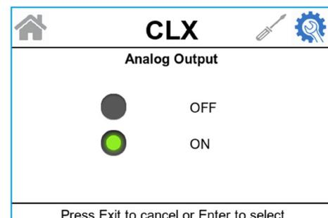
Si la sortie de 4-20 mA a été réglée sur **On**, l'écran suivant invite à régler les limites de chlore de 4 mA et 20 mA, le réglage de l'étalonnage et le niveau d'erreur.
