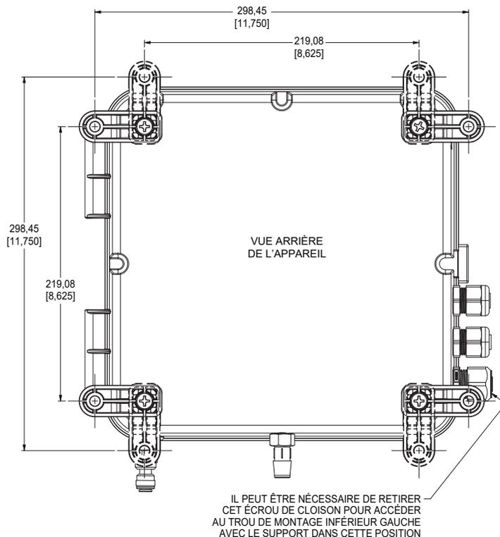
Figure 5 : Dimensions de montage globales de l'instrument
