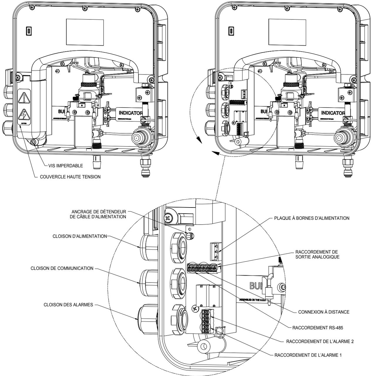
Les bouchons sont insérés dans les passe-câbles RS-485 et 4-20 mA lors de l'expédition, afin d'assurer un joint étanche. Ces bouchons doivent être retirés et mis au rebut lors du câblage de l'une ou l'autre de ces connexions.
