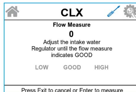
Pour régler la pression du régulateur d'eau, desserrez l'écrou de blocage, puis ajustez le régulateur de pression à l'aide d'une pièce de monnaie ou d'un tournevis à lame plate. Appuyez sur Entrée pour saisir le nombre d'impulsions d'eau. Veuillez noter que seuls des réglages incrémentaux de  $\frac{1}{4}$  de tour doivent être effectués au régulateur à chaque tentative.
