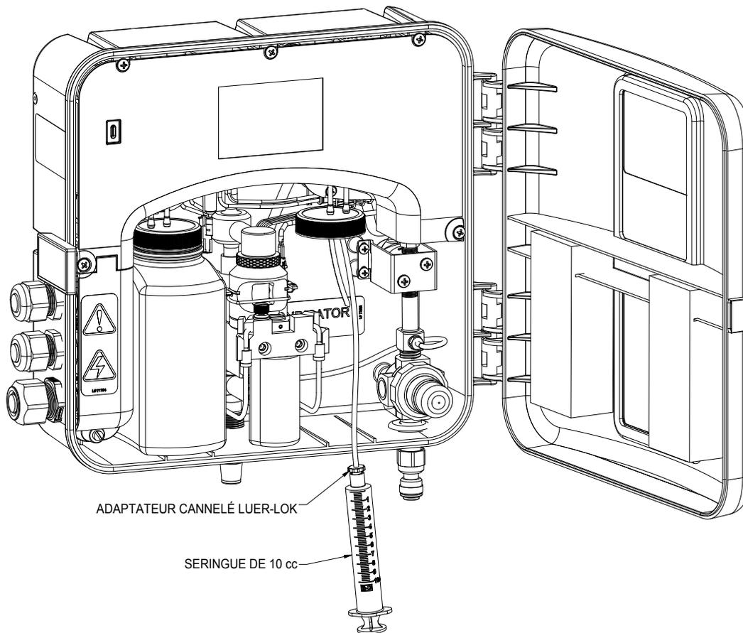
Figure 9 : Trousse de vidange pour clapet antiretour
