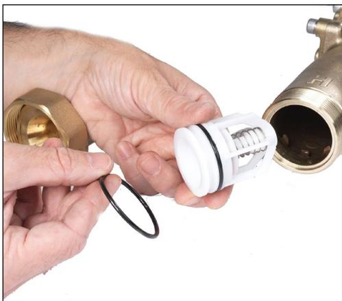
3. Alinee la válvula de retención de repuesto con las ranuras en la entrada y presiónela para insertarla. La junta tórica de entrada debe quedar apoyada contra la válvula de retención y el cuerpo de la válvula, como se muestra en los pasos 1 y 2.
