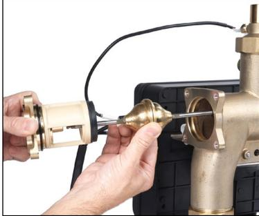
1. Inserte el nuevo émbolo en la tapa terminal preensamblada, asegurándose de que el extremo ranurado de la varilla quede fuera del cuerpo de la válvula.
