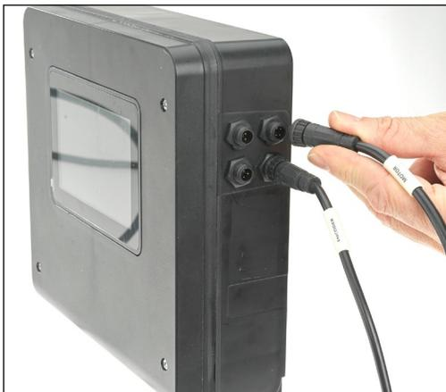
3. Conecte los cables a los puertos ACTR y ENCD en la unidad de control. Los cables están etiquetados como MOTOR y ENCODER, y los conectores están codificados para ajustarse únicamente a los puertos designados.
