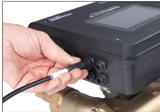
6. Alinee el extremo redondeado del cable con el puerto SENS en la unidad de control, luego inserte el cable y apriete girando el collar del conector en sentido a las manecillas del reloj. Vuelva a conectar todos los cables que hayan sido desconectados.
