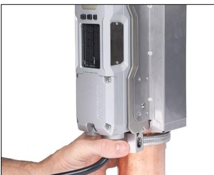
5. Monte la unidad del sensor en el soporte de montaje, asegurándola con los tornillos suministrados.
