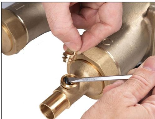
3. Saque el tapón del puerto. Luego, extraiga la junta tórica original si no fue retirada junto con el tapón. Utilice el extremo de la abrazadera de retención o un destornillador para extraerla si es necesario. Repita los pasos 2 y 3 en los otros puertos de sensores.
