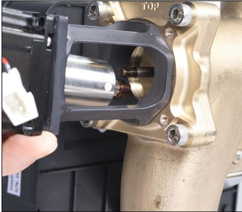
1. Deslice el actuador de repuesto dentro del soporte del tubo.
