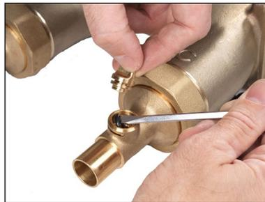
1. Comience con cualquiera de los conectores de entrada y retire la abrazadera de retención y el tapón. (Para obtener instrucciones sobre la extracción del tapón, consulte el procedimiento del paquete de sensores digitales).
