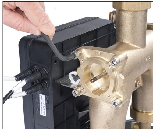
8. Afloje los cuatro pernos de la tapa terminal y retírela del cuerpo de la válvula.
