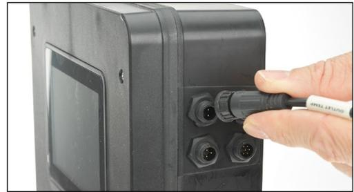
1. Desconecte el cable del sensor del puerto TEMP en la unidad de control.
