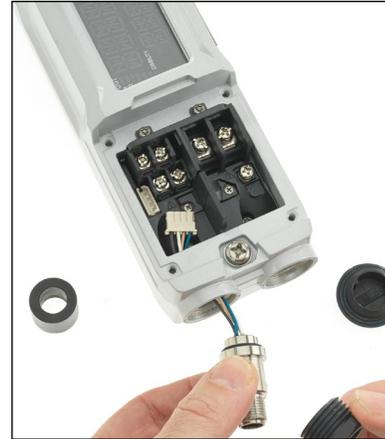
8. Retire la cubierta de la fuente de alimentación y los tapones de los puertos, luego desconecte el cable conector del lado izquierdo y extraiga el cable.
