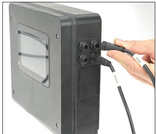
3. Desconecte los cables de los puertos ACTR y ENCD en la unidad de control girando los collares de los conectores en sentido contrario a las manecillas del reloj.
