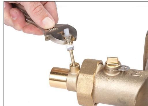
3. Use una llave ajustable para desenroscar el sensor del puerto.
