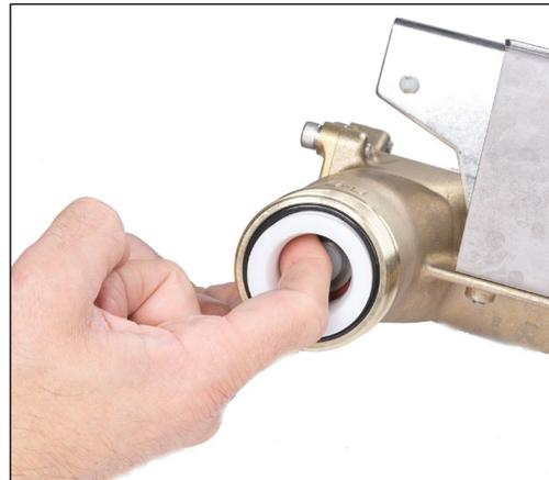
2. Inserte un dedo en el émbolo de la válvula de retención y tome el costado de la válvula para extraerla. Deseche la válvula y ambas juntas tóricas.
