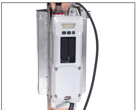
6. Retire la cubierta de goma del puerto del conector en la parte superior de la unidad y enrosque el cable conector del sensor en la unidad principal.
