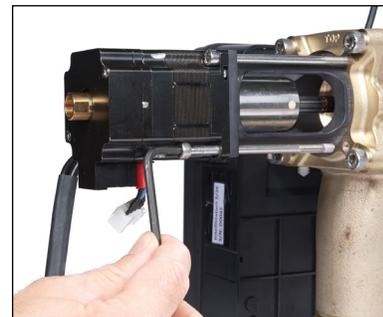
6. Ajuste los pernos para que el actuador quede firmemente asentado en el soporte del tubo y el cuerpo de la válvula. Luego, conecte el cable del actuador al motor y a la unidad de control para completar la instalación. (Consulte los pasos 1, 2 y 3 para referencia visual).
