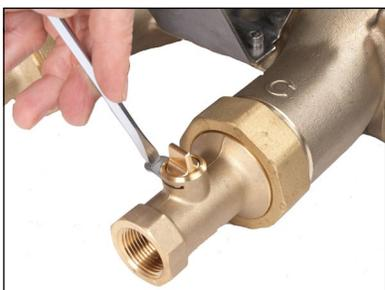
7. Presione la abrazadera de retención con un destornillador hasta que encaje en su lugar. Repita el procedimiento en el otro conector de entrada.
