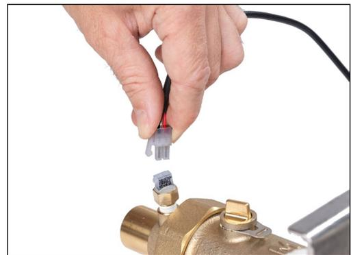
2. Separe el cable del sensor de temperatura analógico presionando la pestaña del conector.
