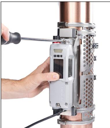
5. Monte la unidad del sensor en el soporte de retención, asegurándola con los tornillos proporcionados.
