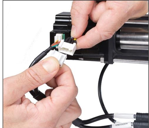
1. Desconecte el conector ACTR grande del puerto ubicado debajo del actuador presionando la pestaña del conector.
