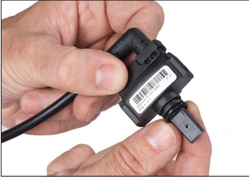
1. Desenrolle el cable e inserte una junta tórica en cada sensor, deslizándola hasta la base del vástago del sensor.
