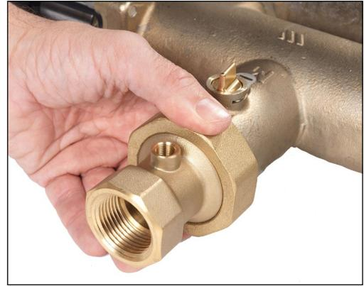
4. Inserte el conector de repuesto a través de la tuerca de montaje. Coloque el conector de salida de repuesto sobre la válvula y la junta tórica, luego apriete la tuerca de montaje. Asegúrese de que el puerto del conector esté orientado en la misma dirección que la pantalla de control.
