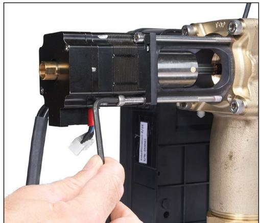
4. Ajuste los pernos para que el actuador quede firmemente asentado en el soporte del tubo y el cuerpo de la válvula. Luego, conecte el cable del actuador al motor y a la unidad de control para completar la instalación. (Consulte los pasos 1, 2 y 3 para referencia visual).
