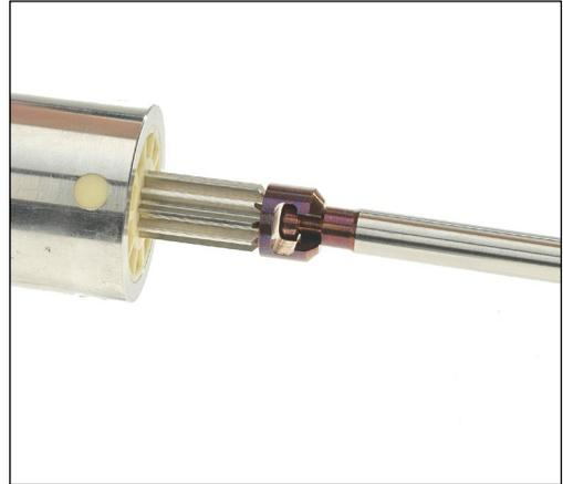
2. Al instalar el actuador en el cuerpo de la válvula, alinee la muesca del acoplamiento con la ranura en el eje y gire el actuador hasta que la ranura encaje en el acoplamiento.
