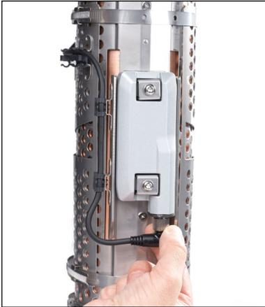
7. Pase el cable conector a través de las abrazaderas del soporte y enrosque el otro extremo del cable en el puerto del conector de la subunidad.
