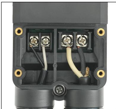
5. Retire la tapa de la fuente de alimentación para cablear el cable de E/S y el cable de alimentación.
