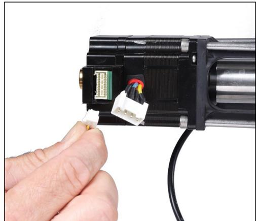
2. Desconecte el conector ENCD pequeño del puerto empotrado en el actuador presionando la pestaña del conector.
