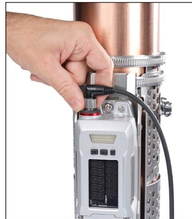
6. Retire la cubierta de goma del puerto de conexión en la parte superior de la unidad y enrosque el cable conector del sensor.
