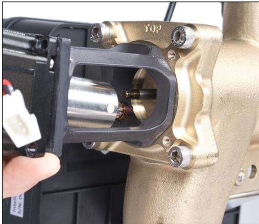
6. Desplace el ensamblaje del actuador para soltar el acoplamiento.
