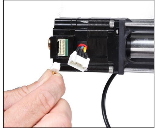
2. Desconecte el conector ENCD pequeño del puerto empotrado en el actuador presionando la pestaña del conector.
