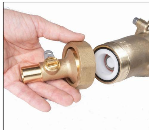
4. Vuelva a instalar el conector colocando la superficie de unión de la entrada contra la junta tórica de entrada y deslice la tuerca de unión en su lugar. Apriete la tuerca lo suficiente para sellar la unión. Repita el procedimiento en la otra entrada.
