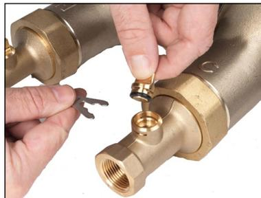
5. Inserte el conector de repuesto a través de la tuerca de montaje. Coloque el conector de salida de repuesto sobre la válvula y la junta tórica, luego apriete la tuerca de montaje. Asegúrese de que el puerto del conector esté orientado en la misma dirección que la pantalla de control.
