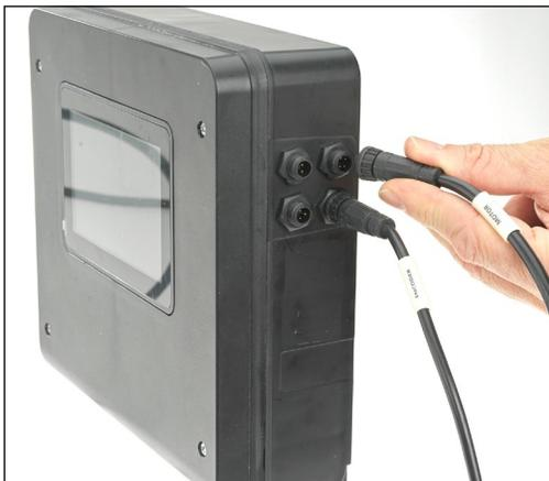
3. Branchez les câbles aux orifices ACTR et ENCD du module de commande. Les câbles sont étiquetés MOTOR et ENCODER et les connecteurs sont clavetés pour s'adapter uniquement aux orifices désignés.
