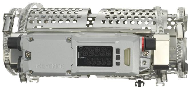
Capteur de débit, dimensions de tuyau 4 po à 5 po
