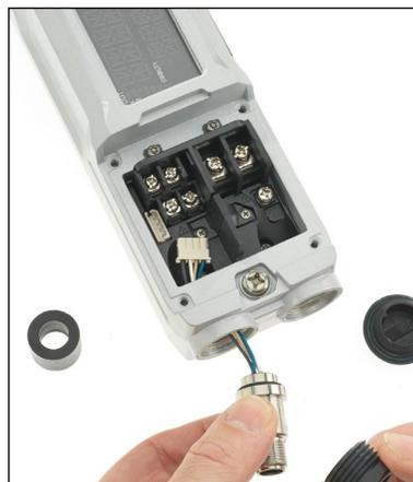
8. Retirez le couvercle de l'alimentation électrique et les bouchons des orifices, puis déconnectez le câble de connecteur sur le côté gauche et tirez sur le câble.
