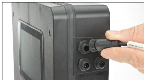
1. Détachez le câble de la sonde du port TEMP du module de commande.
