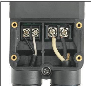
5. Retirez le couvercle du bloc d'alimentation pour câbler le câble d'E/S et le cordon d'alimentation.
