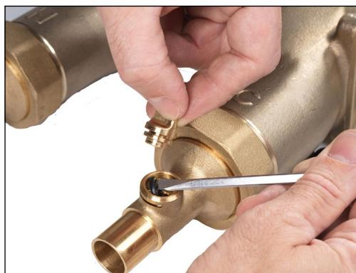
3. Retirez le bouchon de l'orifice. Puis extraire le joint torique d'origine s'il n'a pas été retiré avec le bouchon. Utilisez l'extrémité de la pince de maintien ou un tournevis pour l'extraire si nécessaire. Répéter les étapes 2 et 3 sur les autres orifices de la sonde.
