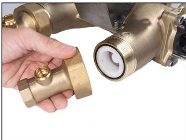
5. Insérez l'about de remplacement dans l'écrou de montage. Positionnez l'about de sortie de remplacement sur la vanne et le joint torique, puis serrez l'écrou de montage. Assurez-vous que l'orifice de l'about est orienté dans la même direction que l'écran de contrôle.
