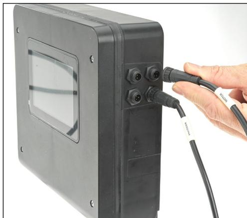
3. Débranchez les câbles des orifices ACTR et ENCD sur le module de commande en faisant tourner les colliers de connecteur dans le sens antihoraire.
