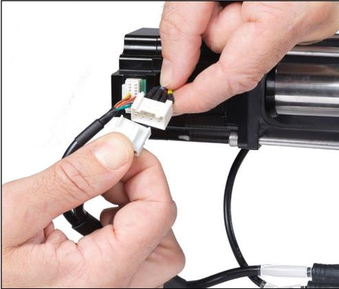
1. Débranchez le plus grand connecteur ACTR de l'orifice sous l'actionneur en appuyant sur la languette du connecteur.
