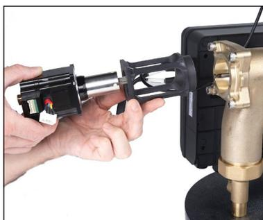
3. Glisser l'actionneur dans le support du tube.
