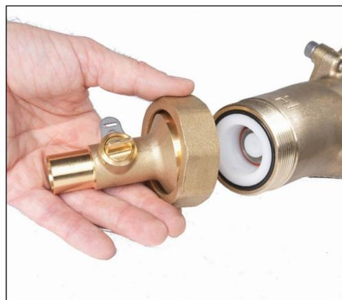
4. Réinstaller la pièce de raccordement en plaçant la surface du raccord d'entrée contre le joint torique d'entrée et en faisant glisser l'écrou du raccord en place. Serrer suffisamment l'écrou pour sceller le joint. Répéter la procédure sur l'autre entrée.
