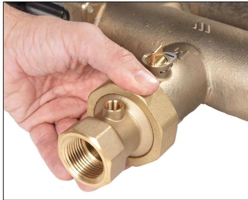
4. Insérez l'about de remplacement dans l'écrou de montage. Positionnez l'about de sortie de remplacement sur la vanne et le joint torique, puis serrez l'écrou de montage. Assurez-vous que l'orifice situé sur l'about est orienté dans la même direction que l'écran de contrôle.
