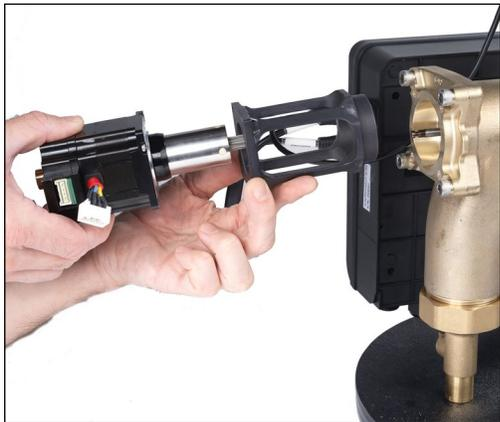
7. Retirez soigneusement l'actionneur et mettez-le de côté.
