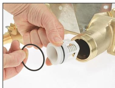
4. Examinez le joint torique au point de raccordement entre la vanne et l'about et remplacez-le si nécessaire, puis réinsérez les pièces en veillant à ce que le joint torique d'entrée repose contre le clapet et le corps de la vanne.
