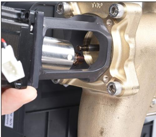
1. Glisser l'actionneur de remplacement dans le support du tube.
