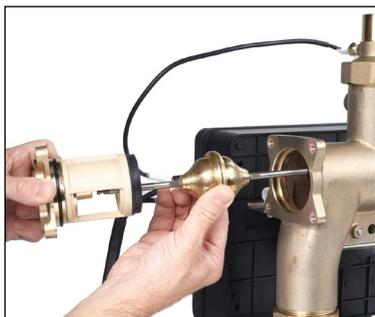
1. Insérez la nouvelle navette dans l'embout préassemblé, en veillant à ce que l'extrémité rainurée de la tige soit située à l'extérieur du corps du robinet.
