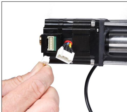
2. Débranchez le connecteur ENCD plus petit du connecteur encastré sur l'actionneur en appuyant sur la languette du connecteur.
