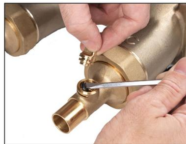
2. Retirez le joint torique à l'aide d'un tournevis ou d'un autre outil.
