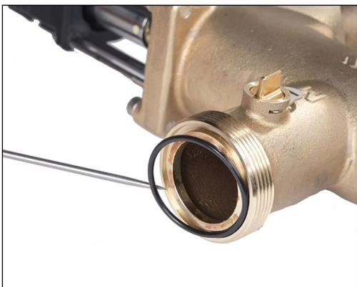
3. Examinez le joint torique au point de raccordement entre la vanne et l'about et remplacez-le si nécessaire.
