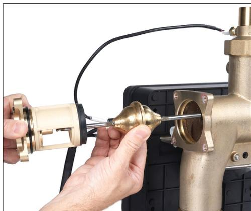
9. Retirer l'embout et la navette du corps de la vanne et les séparer.
