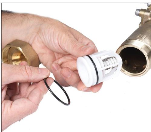
3. Alignez le clapet de remplacement avec les stries dans l'entrée et poussez le clapet de remplacement. Le joint torique d'entrée doit reposer contre le clapet antiretour et le corps de vanne, comme indiqué aux étapes 1 et 2.
