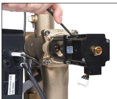
5. Assurez-vous que les connecteurs de câble de l'actionneur sont orientés vers le bas afin que les câbles passent sous l'actionneur. Insérez ensuite chacun des quatre nouveaux boulons à travers le support de tube et dans le corps de vanne.
