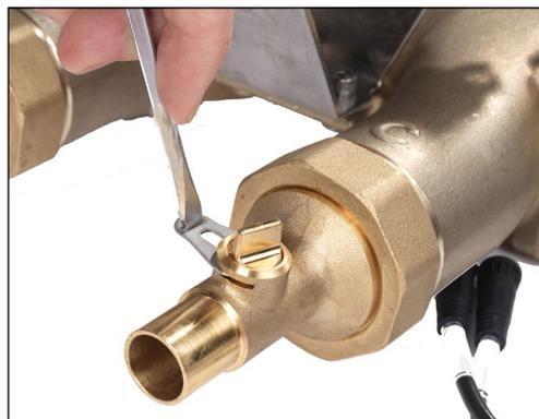
2. Insérez un tournevis dans la rainure du clip de retenue et retirez la pince.
