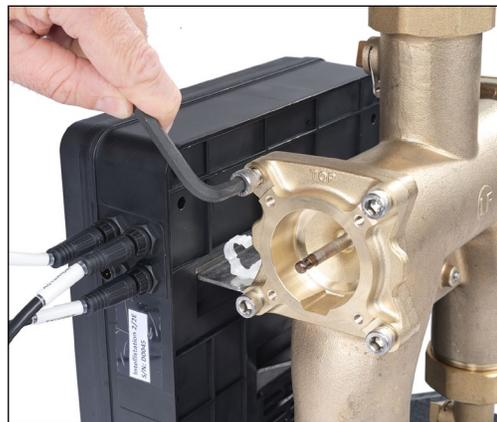
8. Desserrez les quatre boulons de l'embout et retirez-le du corps de vanne.
