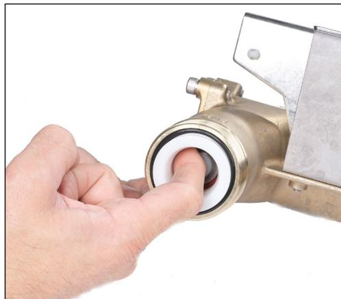
2. Insérez un doigt dans le piston de contrôle et saisissez le côté de le clapet pour le retirer. Mettre au rebut le clapet antiretour et les deux joints toriques.
