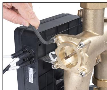
2. Installez l'embout dans le mitigeur en alignant soigneusement la tige de l'inverseur de manière à ce qu'elle s'insère dans l'embout le plus éloigné. (S'assurer que le marquage TOP sur l'embout est situé du côté de la sortie du mitigeur). Réinstallez et serrez les quatre boulons pour mettre l'embout en place. Tirez ensuite la tige de la navette vers l'extérieur à travers l'embout suffisamment loin pour la connecter à l'actionneur.
