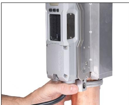
5. Montez l'unité de sonde sur le support de montage, en la fixant à l'aide des vis fournies.
