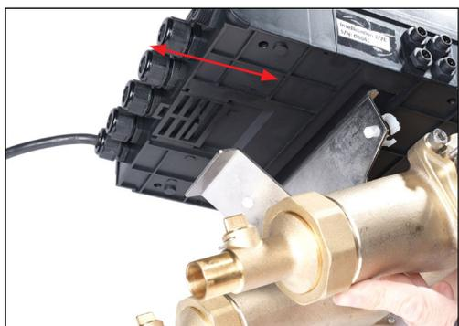
5. Fixez à nouveau le module de commande au cadre de montage s'il a été démonté. Accrochez d'abord l'arrière de l'unité à la partie supérieure du support de montage, puis enfoncez la partie inférieure de l'unité dans le support inférieur. Si nécessaire, tirez légèrement sur la languette de déverrouillage située à l'arrière de l'unité pour guider l'unité dans la position verrouillée.
