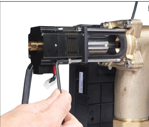
5. À l'aide d'une clé Allen, dévissez les quatre boulons qui se rejoignent l'actionneur au mitigeur; deux d'un côté, deux de l'autre.
