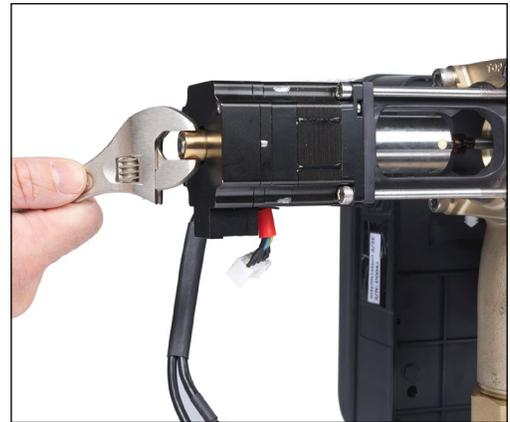
4. Utiliser une clé à molette réglable pour tourner l'écrou en laiton sur l'actionneur dans le sens horaire aussi loin que possible, puis reculer de 5 tours complets.
