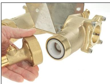
3. Desserrez l'écrou du cordier d'entrée et retirez le cordier de la vanne, puis mettez l'écrou de montage de côté.
