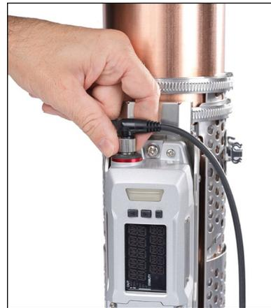
6. Retirez le cache en caoutchouc de l'orifice de connexion situé en haut de l'unité et vissez le câble de connexion de la sonde.
