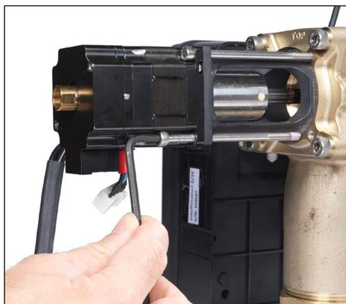
4. Serrer les boulons de manière à ce que l'actionneur soit bien en place dans le support du tube et le corps de la vanne. Fixez ensuite le câble de l'actionneur à le moteur et le module de commande pour terminer. (Voir les étapes 1, 2 et 3 pour une aide visuelle.)
