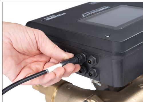
6. Aalignez l'extrémité ronde du câble sur l'orifice SENS de l'unité régulatrice, puis enfoncez le câble et serrez-le en tournant le collier du connecteur dans le sens des aiguilles d'une montre. Rebranchez tous les autres câbles qui pourraient avoir été débranchés.
