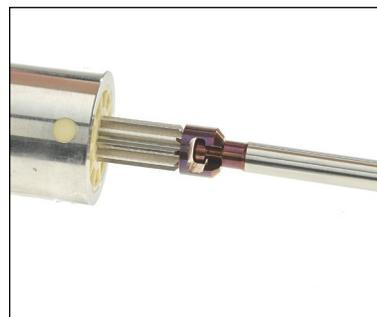
4. Lors de l'installation de l'actionneur sur le corps de la vanne, alignez l'encoche du raccordement avec la rainure de l'arbre et faites pivoter l'actionneur de manière à ce que la rainure glisse dans le raccordement.
