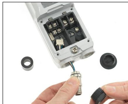
8. Retirez le couvercle de l'alimentation électrique et les bouchons des orifices, puis déconnectez le câble de connecteur sur le côté gauche et tirez sur le câble.
