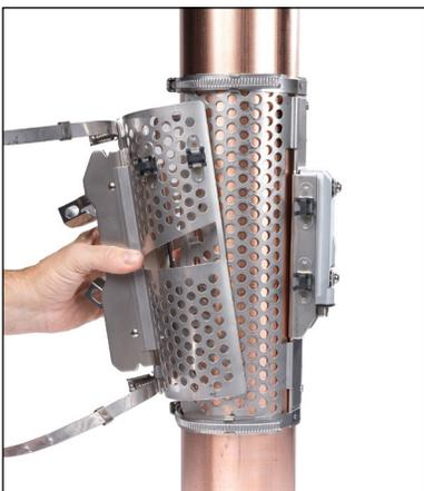
3. Ajouter le support supérieur au support de base, en verrouillant les courroies. Veiller à ce que les petites languettes situées de part et d'autre du support de base s'enroulent autour du bord angulaire du support supérieur.
