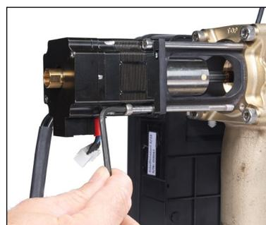
6. Serrer les boulons de manière à ce que l'actionneur soit bien en place dans le support du tube et le corps de la vanne. Fixez ensuite le câble de l'actionneur à le moteur et le module de commande pour terminer. (Voir les étapes 1, 2 et 3 pour une aide visuelle.)
