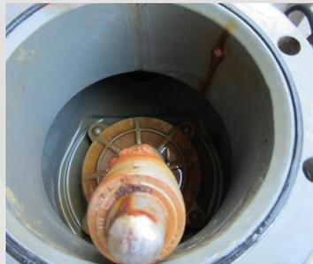
Estas imágenes, tomadas 16 meses después en la misma aplicación que la anterior, muestran poca o ninguna corrosión. Cualquier corrosión ocasionada por una rotura en el recubrimiento no ha progresado.
