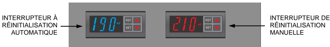
Figure 4-11: Interrupteurs de fin de course de surchauffe
