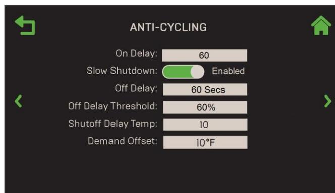
**Figure 6-41 : Operating Controls : Écran d'Anti-Cycling Control**
