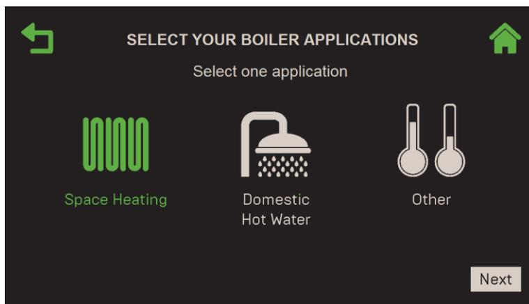
**Figure 2-6 : Standalone : l'écran de Select Boiler Application**
