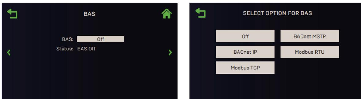
**Figure 6-56 : Communication & Failsafe : Écrans BAS**
