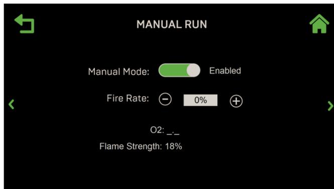
**Figure 4-2 : Diagnostics : Écran de Manual Run – Manual Mode activé**
