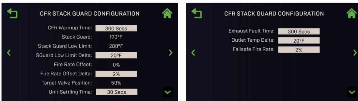
Figure 6-85 : Advanced Setup : Menu de CFR Stack Guard Configuration
