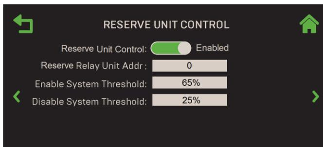
**Figure 6-44 : Operating Controls : Écran de Reserve Unit Control**
