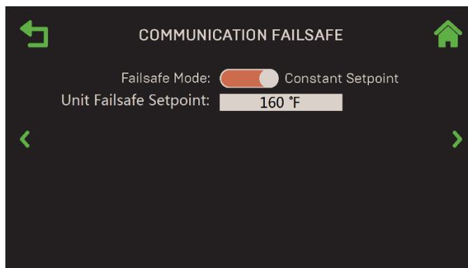
**Figure 6-64 : Communication & Failsafe : Écran de Communication Failsafe**
