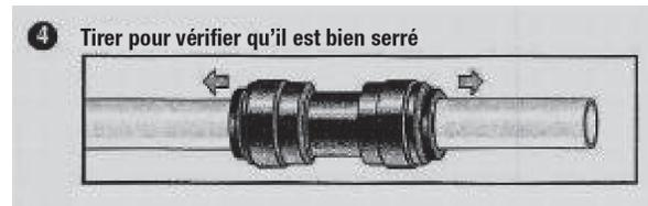
Tirez le tube pour vérifier qu'il est bien coincé. Il est souhaitable de tester le système avant de quitter le site et/ou avant de l'utiliser.
