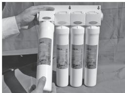
**Étape C** – Veillez à enlever le bouchon du filtre neuf. Insérez la cartouche de filtre neuve dans la tête et faites-la tourner d'un quart de tour jusqu'à ce qu'elle s'arrête. Remplacez la cartouche dans la position verticale.
