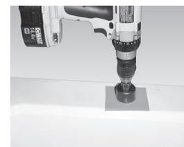
**Étape C** – À l'aide d'une scie-cloche de 1/2 po, percez le grand trou. Percez en restant sur la vitesse la plus lente et utilisez de l'huile de graissage ou du savon liquide pour que la scie-cloche reste froide pendant l'opération.
